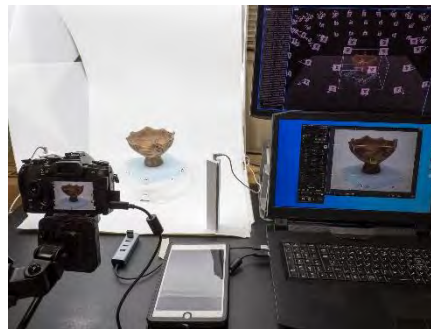
SfM 自動計測機器での撮影
