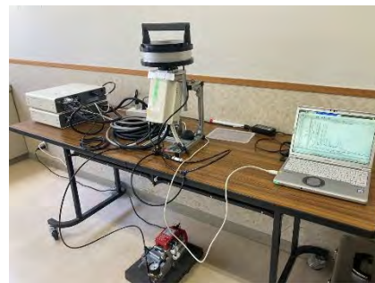
可搬型蛍光 X 線分析装置による京都府奈良岡遺跡出土ガラス製遺物の材質調査 (於：京都府埋蔵文化財調査研究センター)
