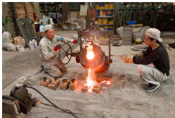
東楼木口金具の鋳造 (10 月 3 日)
