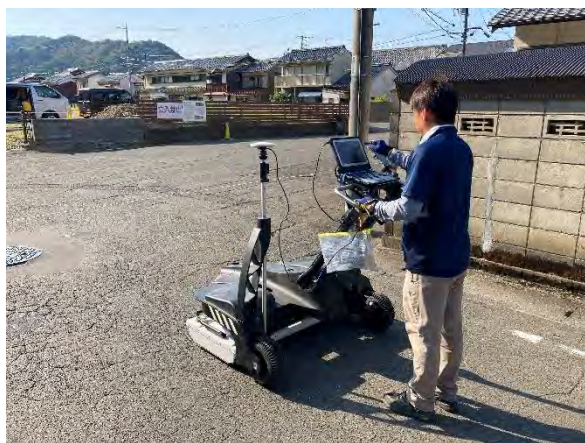
図 1 地中レーダー探査風景
