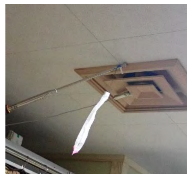
吹き出し口の温湿度測定と 気流調査の様子
