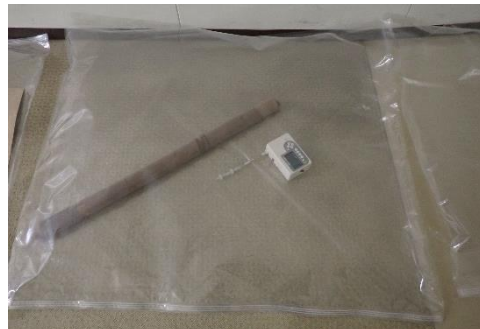
作品に付着した汚染物質の濃度測定の様子
