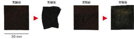
図1 出土木材の保存処理実験における新規薬剤含浸法による寸法安定効果（左：無処置 右：新法規法適用）
