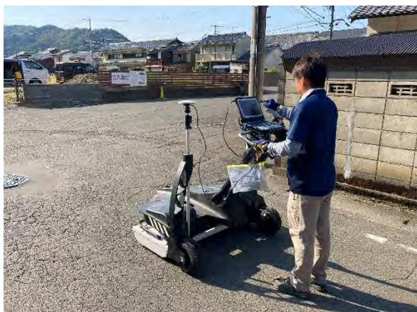
図1 地中レーダー探査風景
