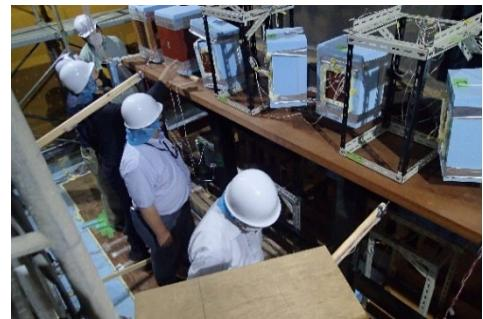
湿度制御温風殺虫処理の内部での各種計測の様子
