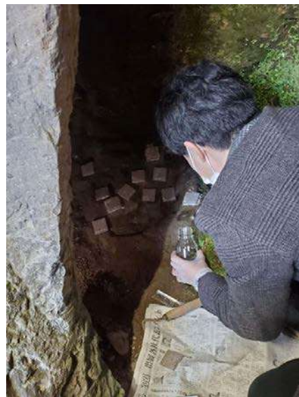
図. 白杵磨崖仏での接着剤選定試験
