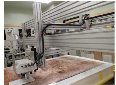
治具に X 線回折分析装置を取り付けた様子
