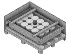
法隆寺金堂壁画の館内輸送前に実施した輸送実験で計測した加速度変化(左)と、設計した実験用梱包箱(右)
