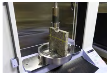
石材目地部分充填材の付着性確認試験
