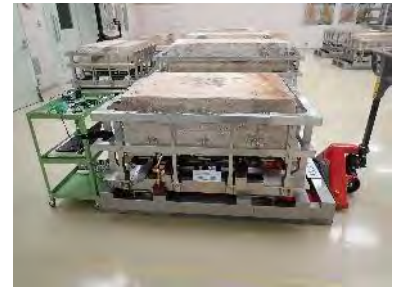
高松塚古墳石材の輸送時加速度計測
