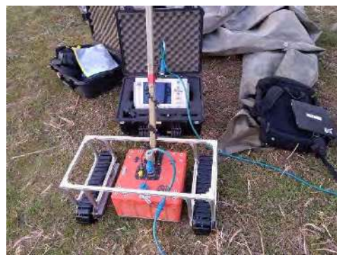
クローラーを用いた地中レーダーの動作試験
