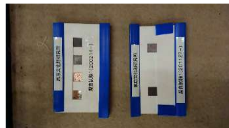
金属試験片を用いた収蔵庫内における 暴露試験
