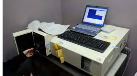
曝露した染色絹布の分光光度測定
