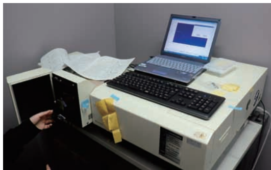
曝露した染色絹布の分光光度測定（東京文化財研究所）
