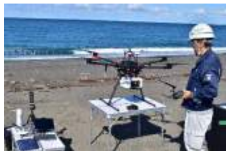
グリーンレーザーによる探査の様子 (北海道上ノ国町)
