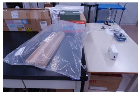
サンプリングバッグ法による桐箱から発せられる化学物質量の測定
