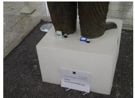
展示室内における空気汚染調査の様子
