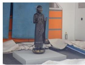
起震車を使用した振動計測実験
