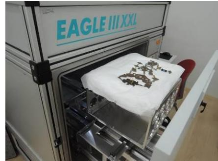
据え付け型萤光 X 線分析装置による測定
