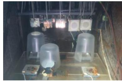
図1 模擬古墳での劣化試験の様子
