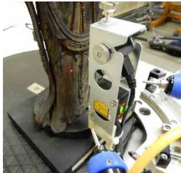
X線回折分析による銅造仏の材質調査
