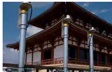
第一次大極殿で実施している環境調査（日射、照度、紫外線）
