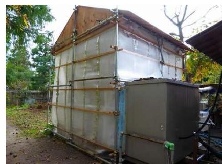
モデル処理建物の温風処理実験の様子
