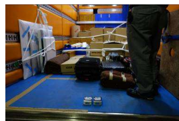
トラック荷台上での振動計測
