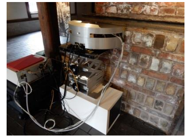
可搬型X線回折分析装置による煉瓦造建造物の調査
