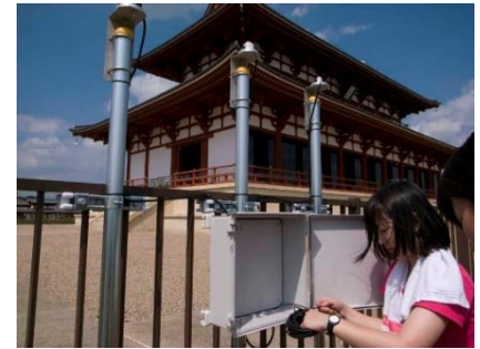
図 平城宮復原大極殿日射計設置風景
