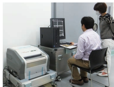
可搬型現像装置を用いたX線透過撮影による調査
