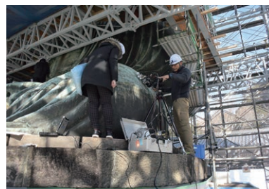
調査風景(可搬型X線回折分析装置による分析)
