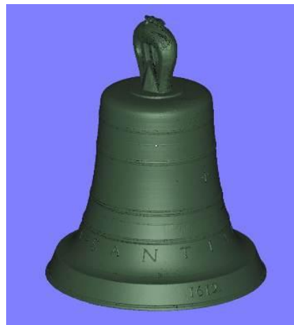
3Dデジタイザで精密に三次元計測した 竹田市教育委員会所蔵南蛮鐘
