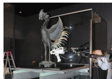
ハンドヘルド蛍光X線分析装置を用いた金属文化財のその場分析
