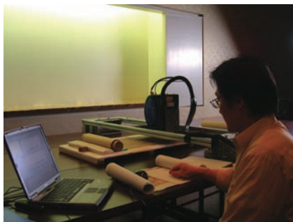
ポータブル蛍光X線分析装置による絵巻の彩色材料調査 Analysis of painting materials using a portable X-ray fluorescence spectrometer
