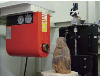
デバイスを更新したマイクロフォーカスX線CT装置による木彫神像の年輪年代調査 Dendrochronological research of a wooden statue of a deity using the newly replaced Microfocus X-ray CT System, exchanged for new source
