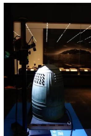
梵鐘の調査風景（3次元デジタルアナライザによる実測）
