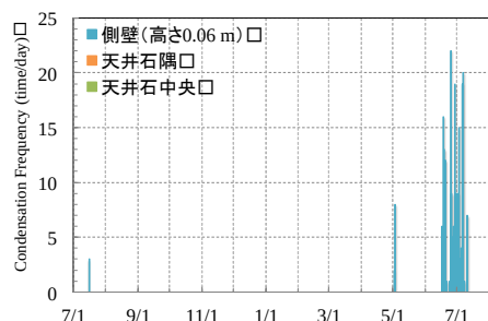
ガランドヤ古墳結露発生回数の変化（上：防水シートあり、下：保護施設内（現在））
