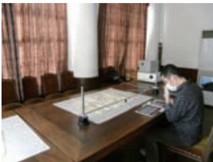
近世絵図資料に使われている色材の可視分光法による調査 Investigation of coloring materials used on early modern Japanese maps with visible reflection spectroscopy
