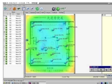
無線 LAN 温湿度管理システムによる 展示ケース内 24 時間温湿度監視用 PC モニター画面
