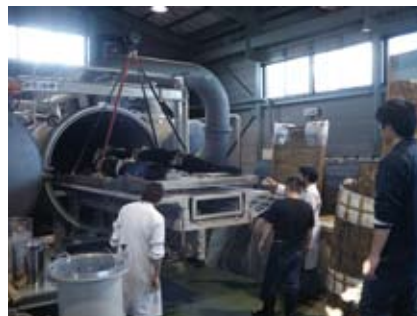
大型木製遺物の真空凍結乾燥法による保存処理 Vacuum Freeze-Drying of large-sized archaeological waterlogged wooded objects
